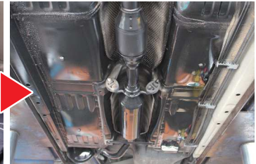
▲ サビを抑え光沢のある仕上がりに。防錆効果だけでなく、遮音性も高まりました。
