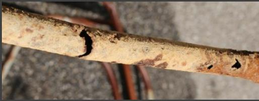
サビの腐食によってボロボロになったビニールハウスのパイプ
